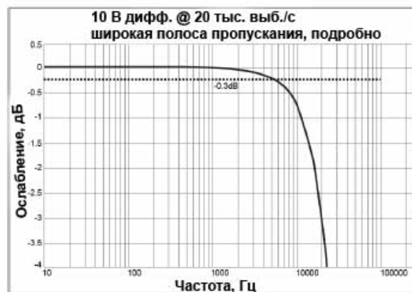
Рисунок 1.2: 10 В дифференциальное @ 20 тыс. выб./с - подробно
