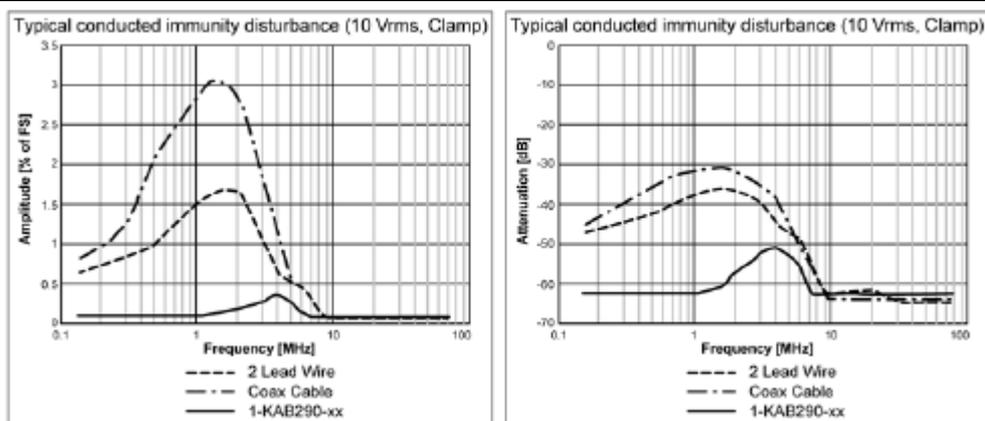
**Рис. 1.13.** Типовая проводящая устойчивость, испытание в диапазоне  $\pm 10 \text{ В}$
