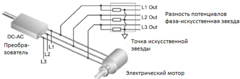
Рис. 1.15. Типовой пример использования адаптера
