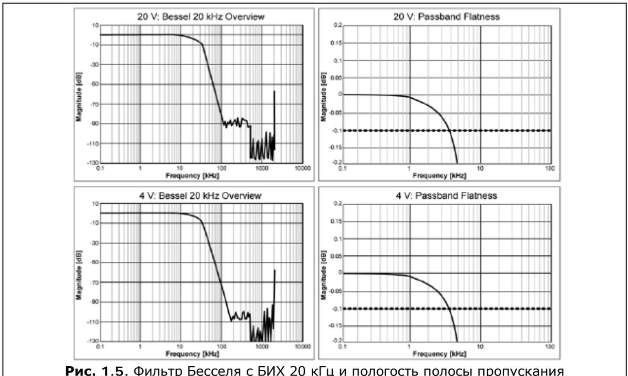
**Рис. 1.5.** Фильтр Бесселя с БИХ 20 кГц и пологость полосы пропускания
