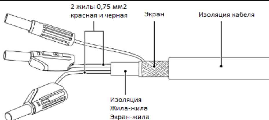
**Рис. 1.12.** Устройство экранированного кабеля
